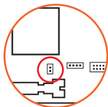
图2-1 清除CMOS跳线
