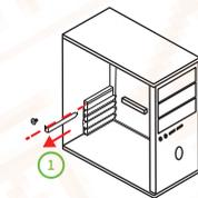
1. 用螺丝刀拆除主机箱上的挡板和螺丝
