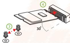
3. 拧紧旋入长度M.2模块到M.2接口距离孔的螺丝底座
