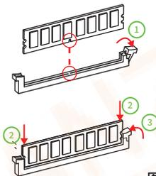
1. 将内存插槽两端的卡扣往外扳开, 内存条与插槽的凸出位置做对应, 确定安装的方向
