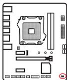
图2-1 清除CMOS跳线
